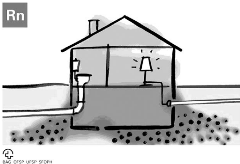
Illustration 2: Eine undichte Betonplatte und zahlreiche Zuleitungen erleichtern das Eindringen von Radon in ein Gebäude.
