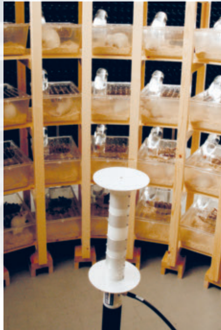
Système d'exposition en bois pour les animaux de laboratoire de l'étude Ramazzini 12 , cf. légende p. 19. © zvg
