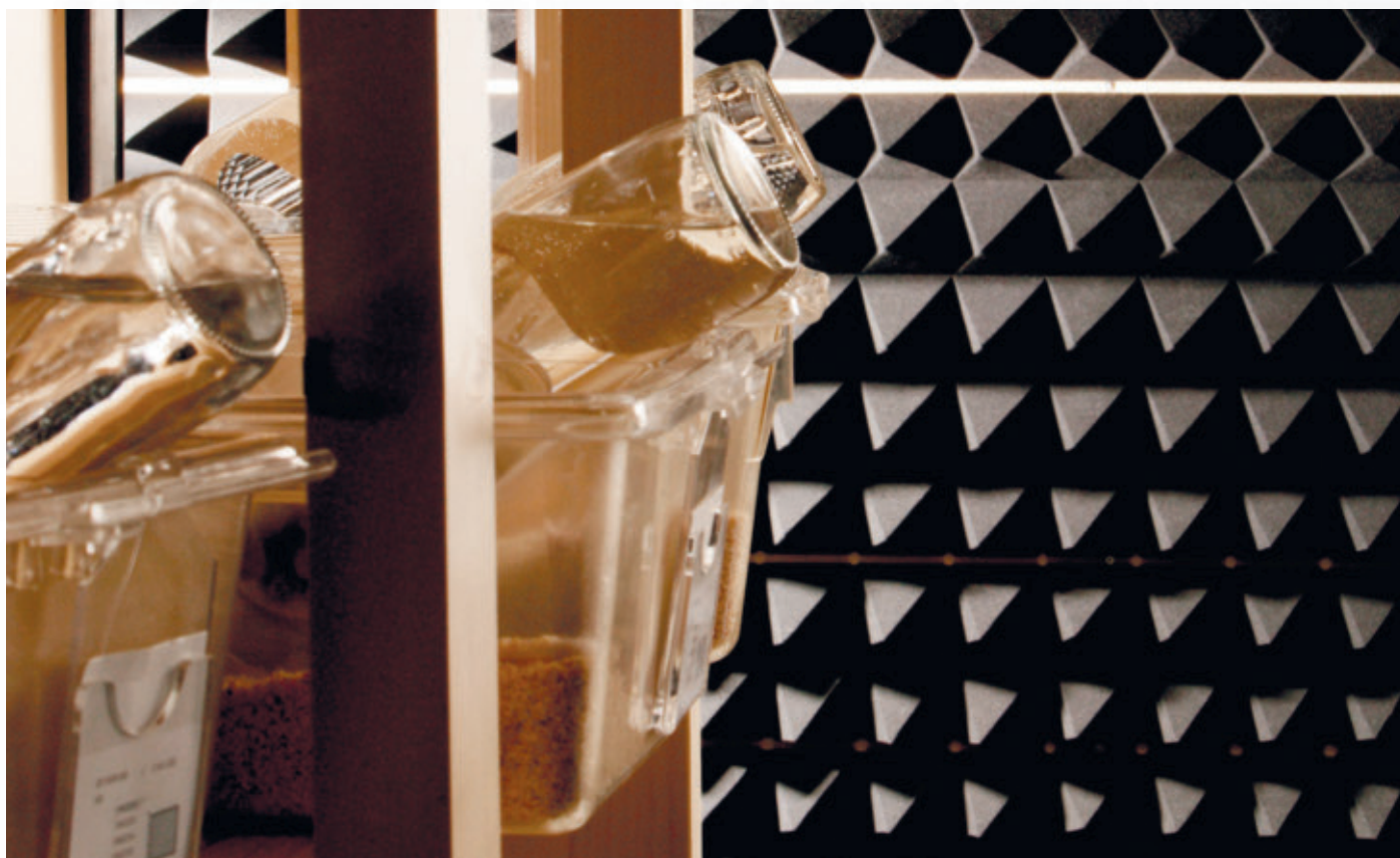
Dans l'étude Ramazzini, 12 chaque pièce du système d'exposition avait des murs blindés pour empêcher une réflexion des ondes.
