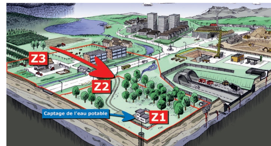
Le captage d'eau potable extrait de l'eau souterraine et est entouré des zones de protection Z1 – Z3 (lignes rouges). La qualité de cette dernière dans le captage peut être influencée par des exploitations en dehors des zones de protection. Ainsi des substances mobiles – les PPH, leurs produits de dégradation ou du nitrate issus de l'agriculture pratiquée très loin – peuvent parvenir jusque dans le captage (flèche rouge).
