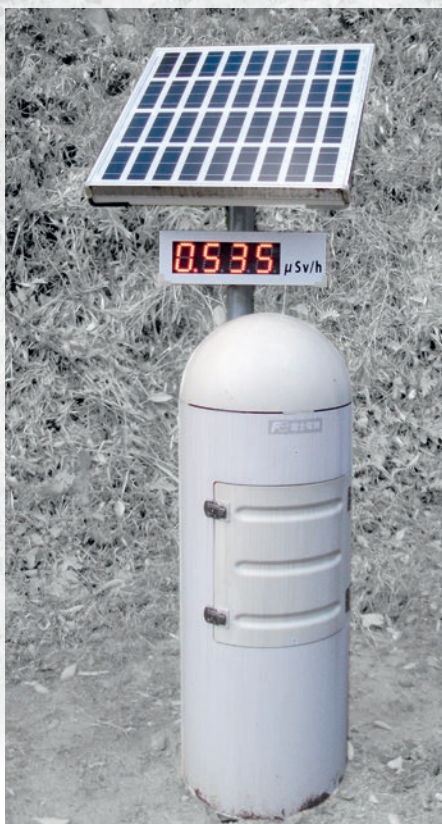
Exemplaire de l'un des intensimètres du contrôle étatique mesurant de manière erronée à Fukushima en 2012. De plus, il est muni de cellules solaires, l'affichage n'a donc lieu que le jour et pas la nuit. © Thomas Dersee
