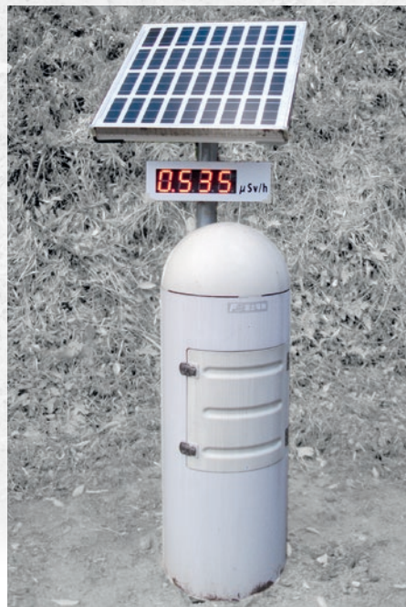
Exemplar eines der falsch messenden Dosisleistungsmessgeräte des staatlichen Monitorings in der Stadt Fukushima im Jahr 2012. Die solarbetriebene Anzeige funktioniert nur tagsüber.
