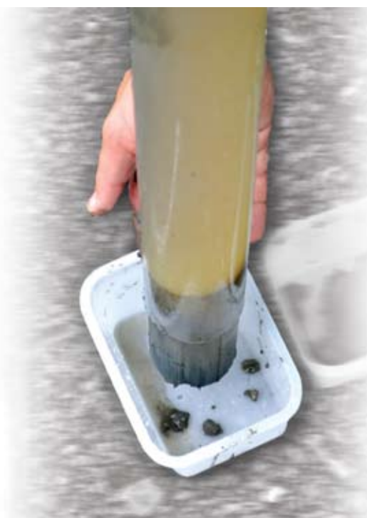
Bohrkern aus dem mit zahlreichen Chemikalien belasteten Sediment des Grossgrundkanals bei Visp (VS). © oekoskop
