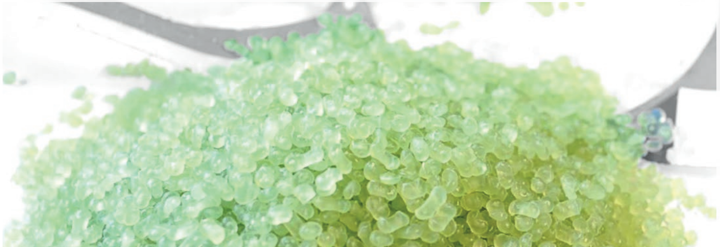
Aus Produktionsstanzabfällen hergestelltes PLA 3 -Regranulat.
