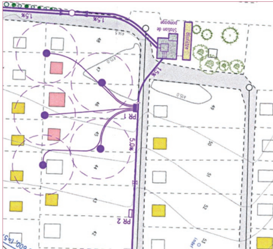
Gassamelsystem mit Absaugbrunnen, Steuerungsstation und Aufbereitungsanlage.
