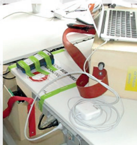
Die Einrichtung misst über einen längeren Zeitraum die hochfrequenten elektromagnetischen Felder (von Mobilfunk, W-LAN, usw.) an einem Arbeitsplatz im Greenpeace-Büro.
