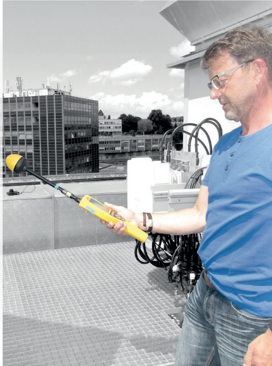
Markus Gugler misst mit einer Breitbandsonde (100 kHz bis 3 GHz) die hochfrequente Strahlung, die von den umliegenden Mobilfunkanlagen bei der Greenpeace-Adresse in Zürich eintrifft.
