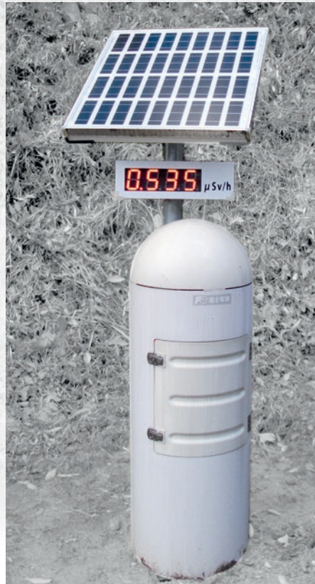
Exemplaire de l'un des intensimètres du contrôle étatique mesurant de manière erronée à Fukushima en 2012. De plus, il est muni de cellules solaires, l'affichage n'a donc lieu que le jour et pas la nuit.
