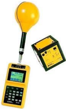
Fig. 7-7: Elektrische und magnetische Feldmessgeräte (Quelle: Narda-STS)
