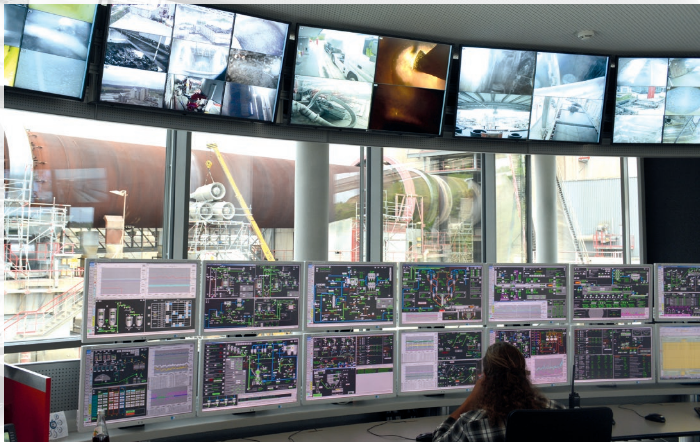
Technologie de pointe: centrale de commande de la cimenterie d'Allmendingen (D) avec vue sur le four rotatif. Un employé surveille tout, même le respect des valeurs des gaz résiduels.
