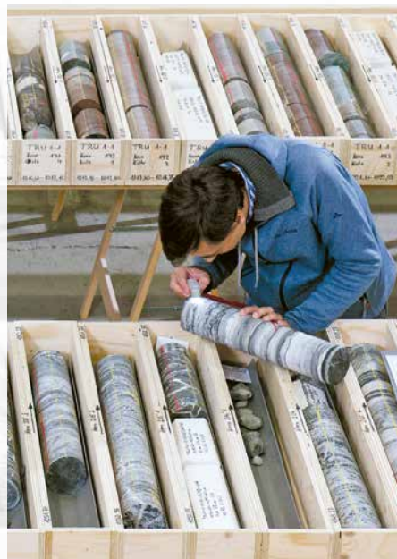
Zwischenlager mit Bohrkernen aus der Untersuchung des Tiefenlagerstandorts.
