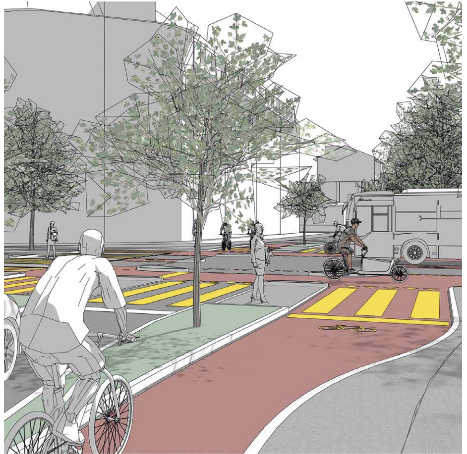
Kreuzung heute (kleines Bild) und à la E-Bike-City. Die Trennung der Verkehrsträger reduziert Konflikte. Engere Autospuren drosseln das Tempo und machen Velofahren und Menschen zu Fuss sicherer. © ETH Zürich
